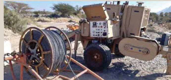
TESMEC (puller) Model. ARS 500
