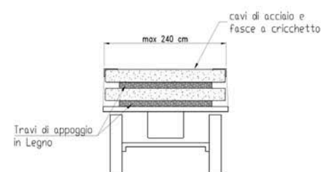
Disposizione elementi Fast Site I° Bilico (Peso 29280 kg)
